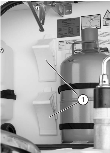
Hjulkile i gasskassen
